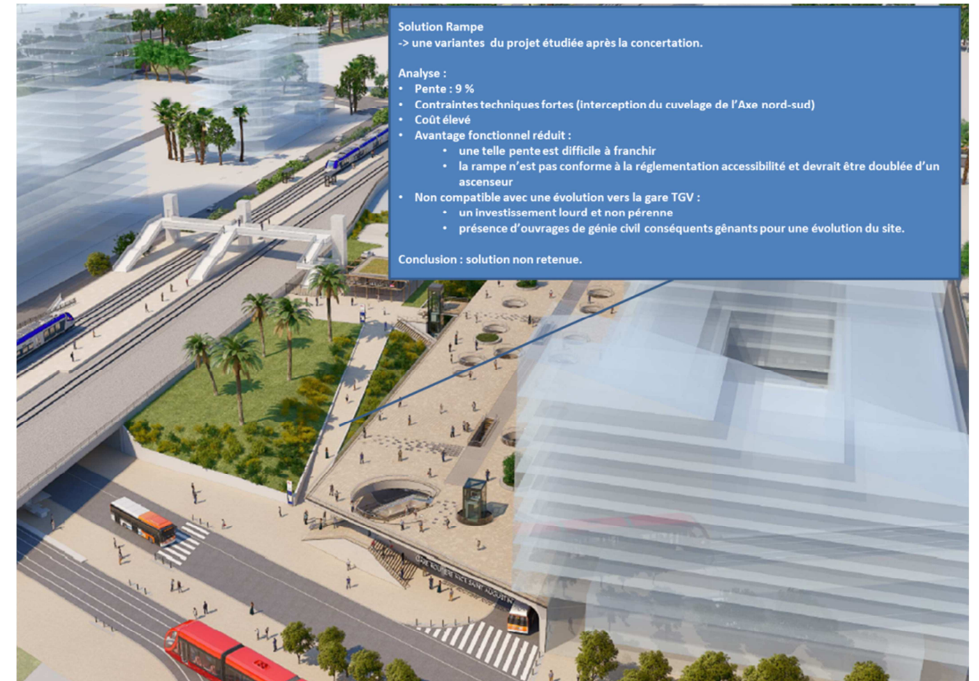
Figure 1 - PEM Nice St. Augustin - variante d'accès par rampe à 9%.
