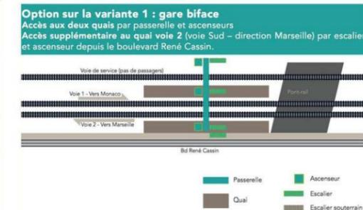
Figure 4bis : schéma d'accès aux quais par passerelle et ascenseurs + accès direct au quai sud depuis le boulevard Cassin (source : SNCF Réseau / Réalisation : Magellan)
