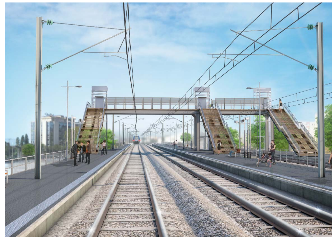
Vue de principe de l'insertion de la passerelle depuis les quais (SNCF Réseaux)
