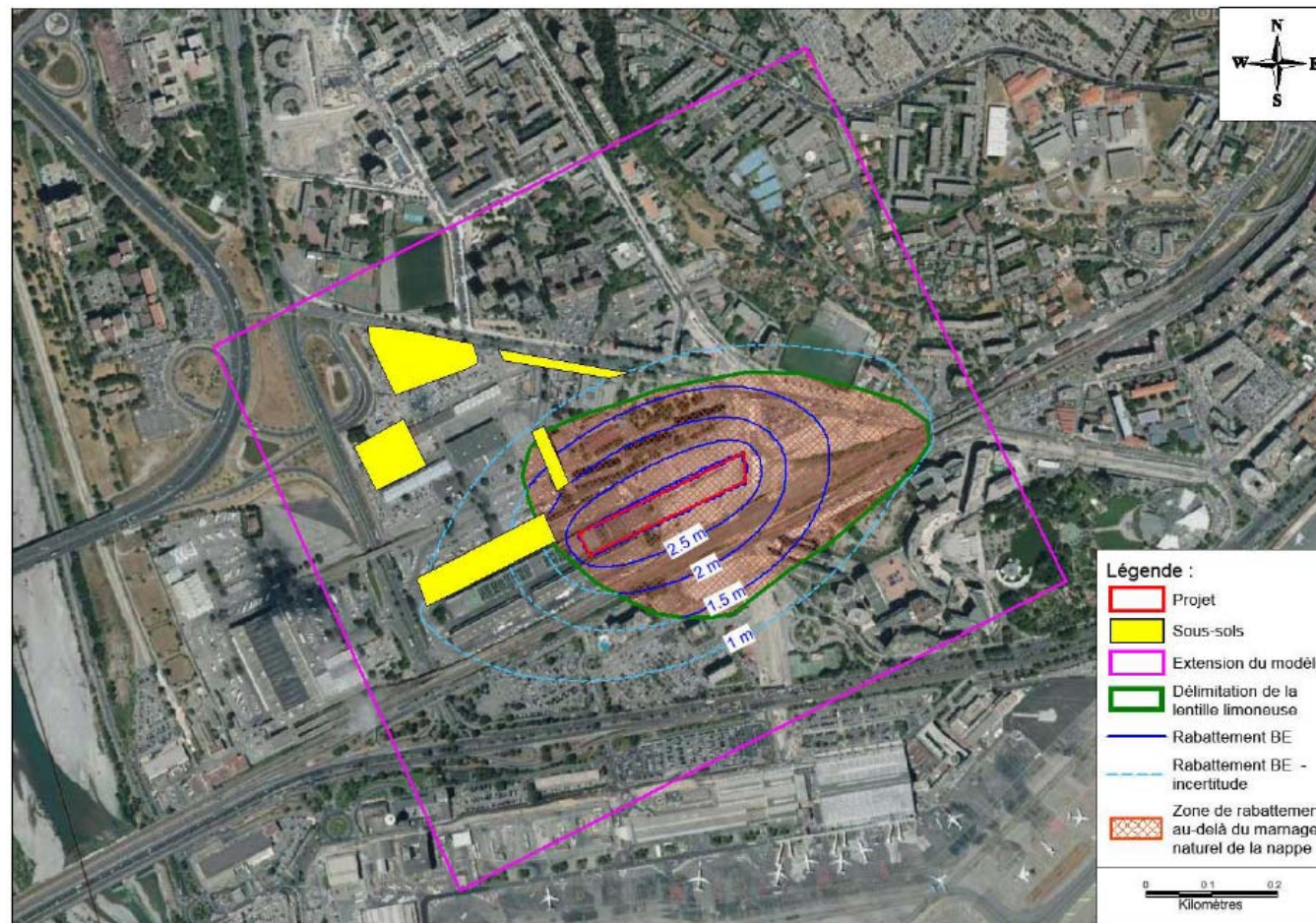
Figure 137 : Cône de rabattement du projet en période de basses eaux (abaissement en dessous des niveaux de basses eaux)
