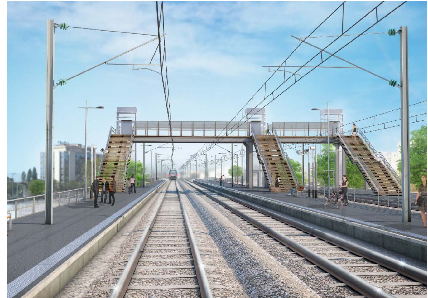
Figure 15 - Vue de principe de l'insertion de la passerelle depuis les quais (SNCF Réseaux)
